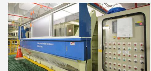
台積公司打造首座「氫氟酸廢液合成冰晶石系統」
